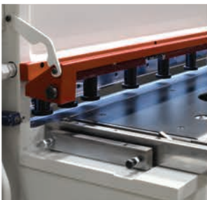
1000 mm açılabilir, emniyet siviçli ön muhafaza 1000 mm lift-up front finger guard with electrically interlocked safety switch
