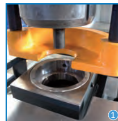
GDDA Zimba ölçüsü: 58 - 85 mm GDDA punch size 58-85 mm Адаптер для пробивки отверстий 58-85мм
