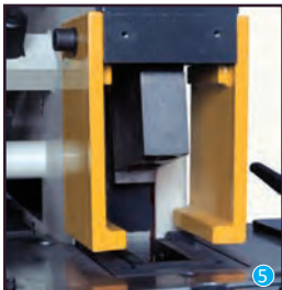
U çentik açma istasyonu U-notching station Высечка
