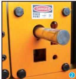
Yuvarlak mil kesme istasyonu Round solid bar cutting station Резка круглого прутка
