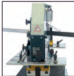
Açılı köşebent kesme Angle section ( 45^\circ ) cutting Резка уголка под углом
