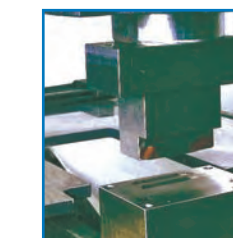
Panjur kalıbı Louvre punching tool Пробивка жалюзи
