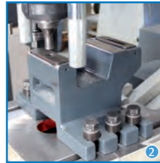
IPN/UPN ve Köşebent delme kalıbı IPN/UPN and angle punching tool Приспособление для пробивки IPN/UPN уголка
