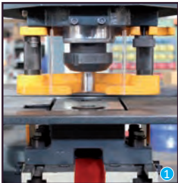
Zımbalama istasyonu Punching station Пробивка отверстий
