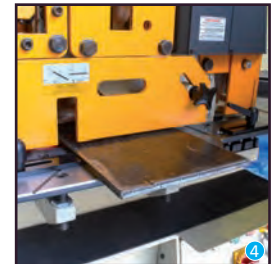
Lama kesme istasyonu Flat Bar cutting Station Резка листа
