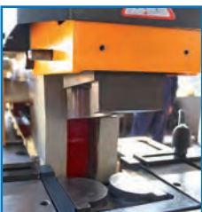
Lama radyus açma kalıbı Flat bar radius tool Комплект инструмента для радиусной пробивки сложных форм
